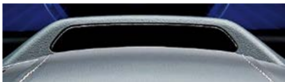
図4 ドライバーモニターシステム(カメラとLED搭載)
