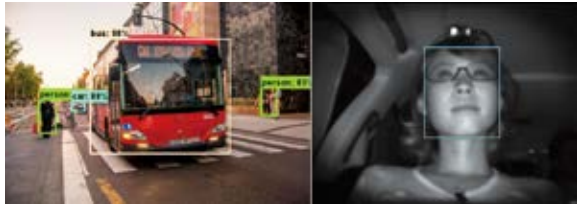
図2 一般物体検出モデル(左)とアイシンモデル(右)
