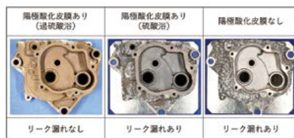
図2 複合サイクル試験後の製品評価結果
