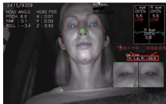
図12 角膜反射法使用時例
