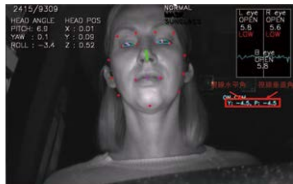
図11 角膜反射法不使用時例
