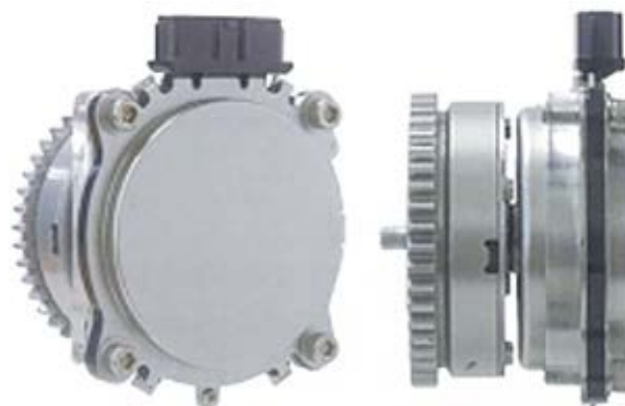
図1 アイシン製電動VVT(モータ+変換部)
